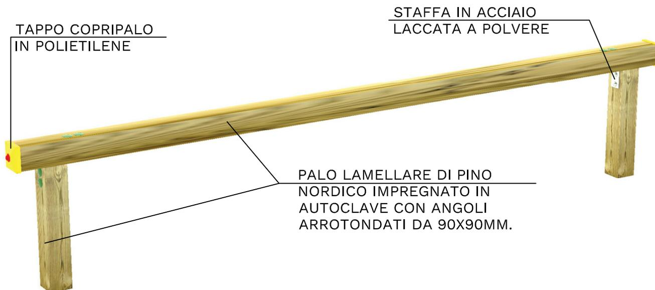
TUTTI GLI ELEMENTI DI FISSAGGIO, VITI, DADI, RONDELLE ECC. SONO IN ACCIAIO ZINCATO E PROTETTI DA GHIERE E TAPPI IN POLIETILENE.
